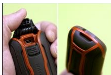
Слева: верхняя часть навигатора (разъем USB). Справа: нижняя часть (крепление для ремешка)
